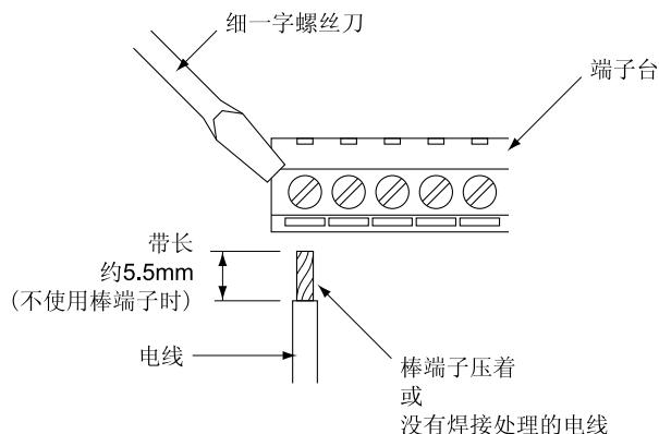
※拧紧螺栓时，超转矩进行时，端子台有破损的可能。而用力太弱时，可能成为误运作·短路的原因。
