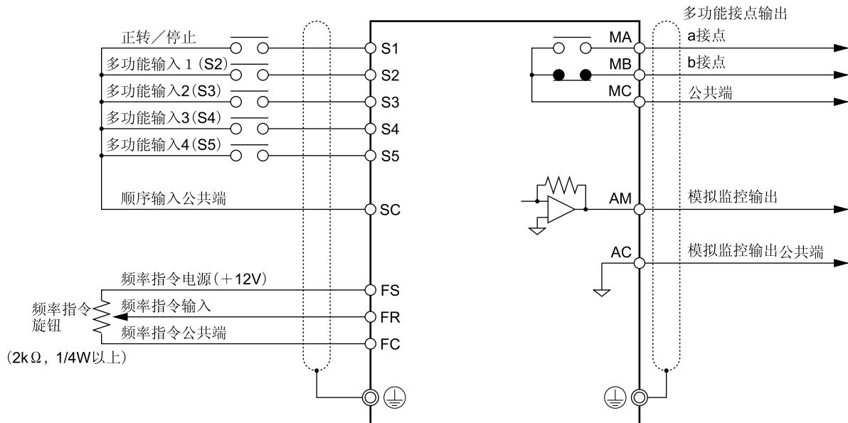
※所有输入输出信号可以都配线至1根屏蔽电缆上。
