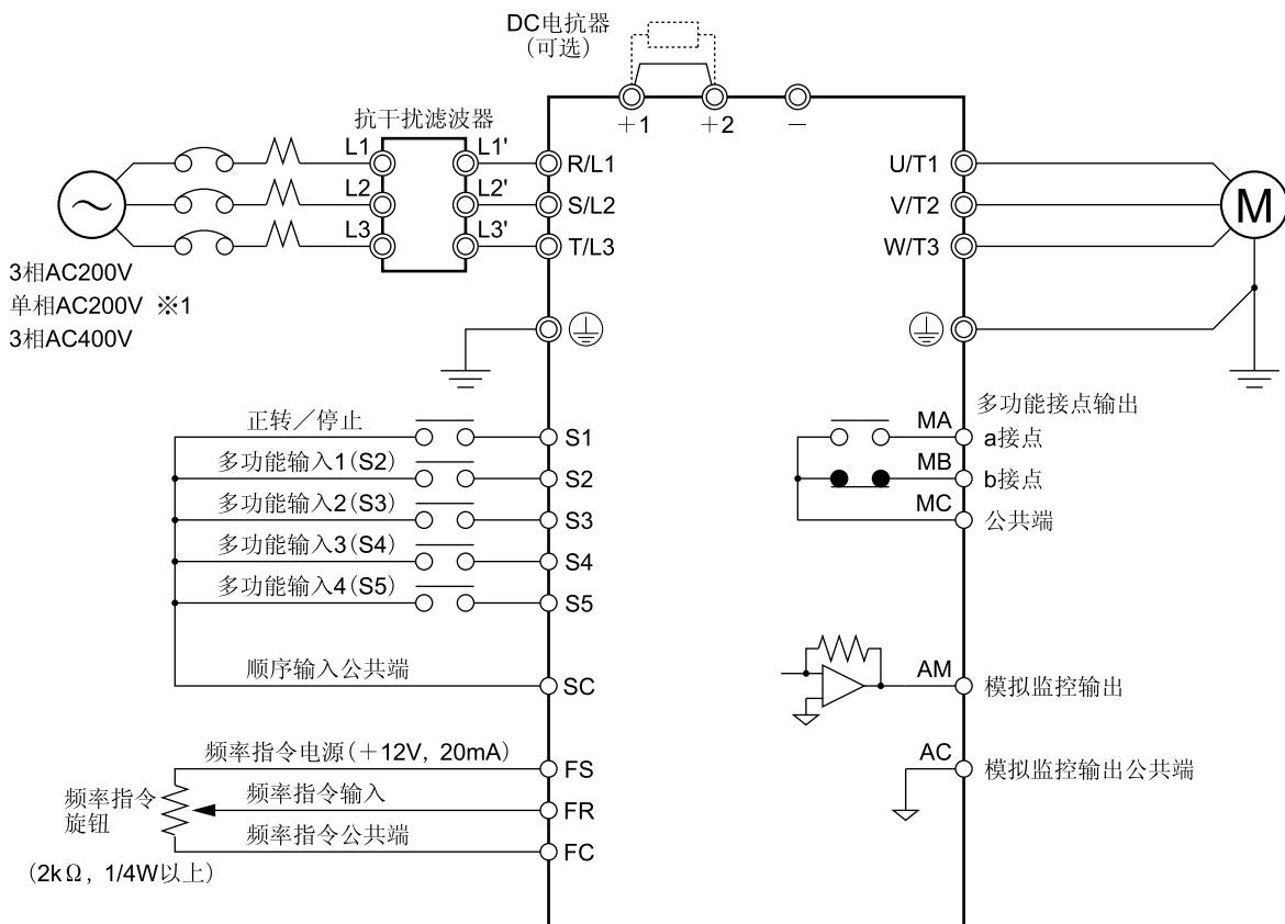
※1. 3G3JV-AB□, 将单相AC200V连接于R/L1, S/L2的2端子上。
